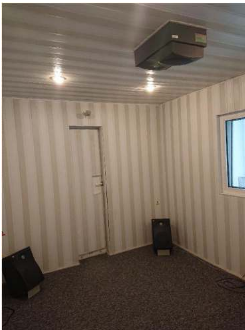
Rys. 8.2. Kabina służąca do pomiarów tłumienia dźwięku
