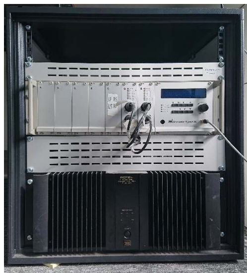
Rys. 8.1. System służący do pomiarów tłumienia dźwięku Norsonic Nor838 wraz ze wzmacniaczem Rotel RMB-1075
