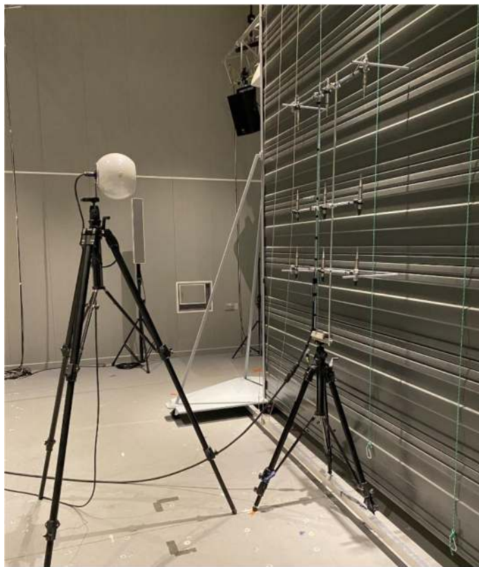
Rys. 6.4. Stanowisko pomiarowe w komorze akustycznej
