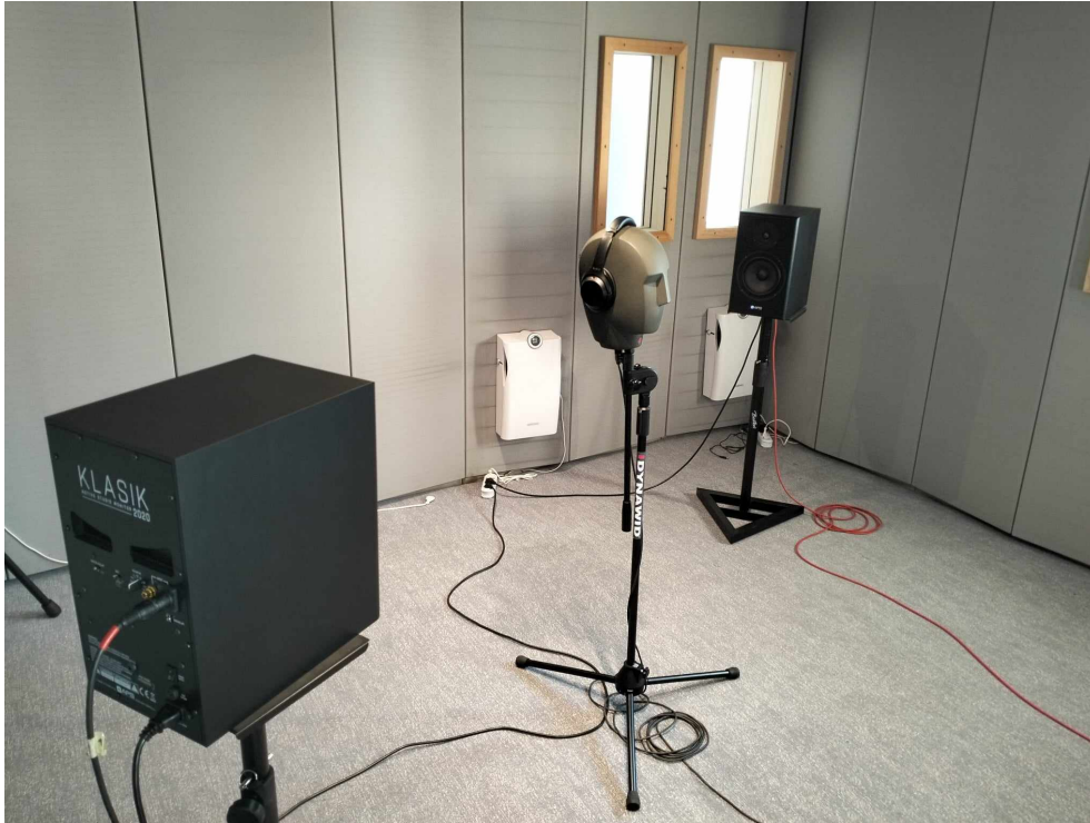
Rysunek 2: Rzeczywisty układ pomiarowy wykorzystany do pomiaru tłumienia słuchawek
